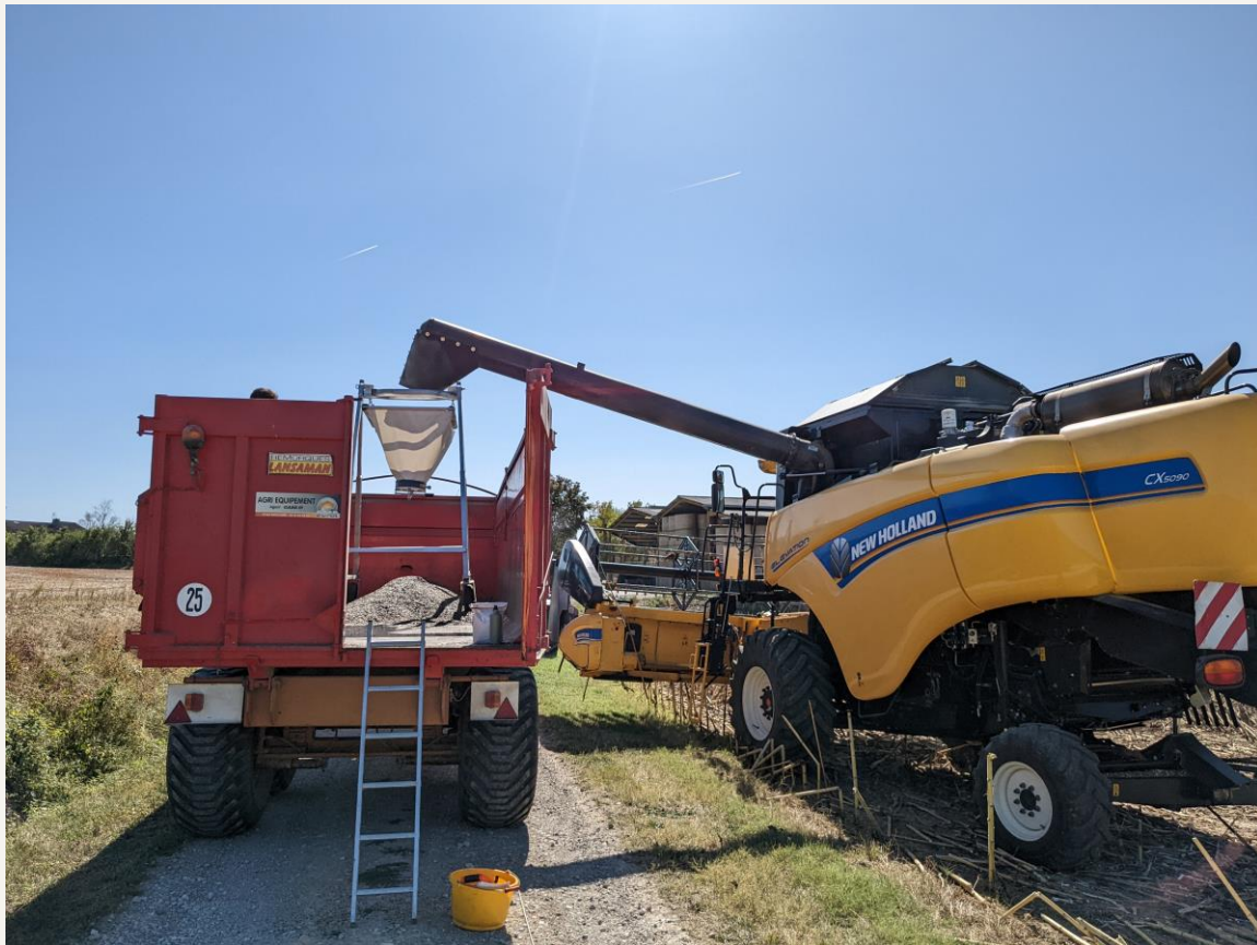
Mesure du rendement du tournesol avec une trémie peseuse
